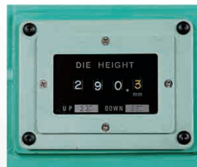
Indicador de altura da ferramenta com precisão decimal
