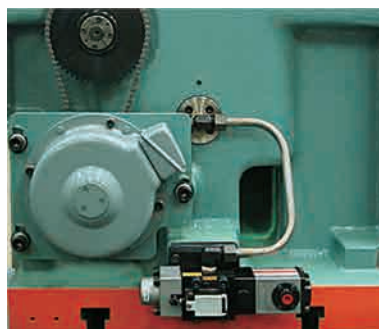
Ajuste motorizado da altura do martelo (de 60t para cima)
