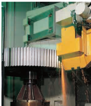
Engrenagem principal tratada e retificada
